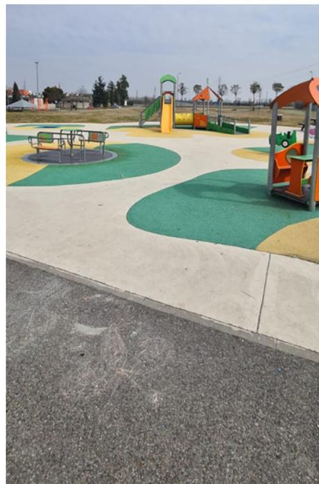
Nelle due immagini sopra, render di progetto di due aree gioco accessibili. Nelle immagini a lato esempi di parchi gioco accessibili realizzati con pavimentazione in gomma colata e attrezzati con giochi inclusivi, utilizzabili anche da bambini con fragilità.
